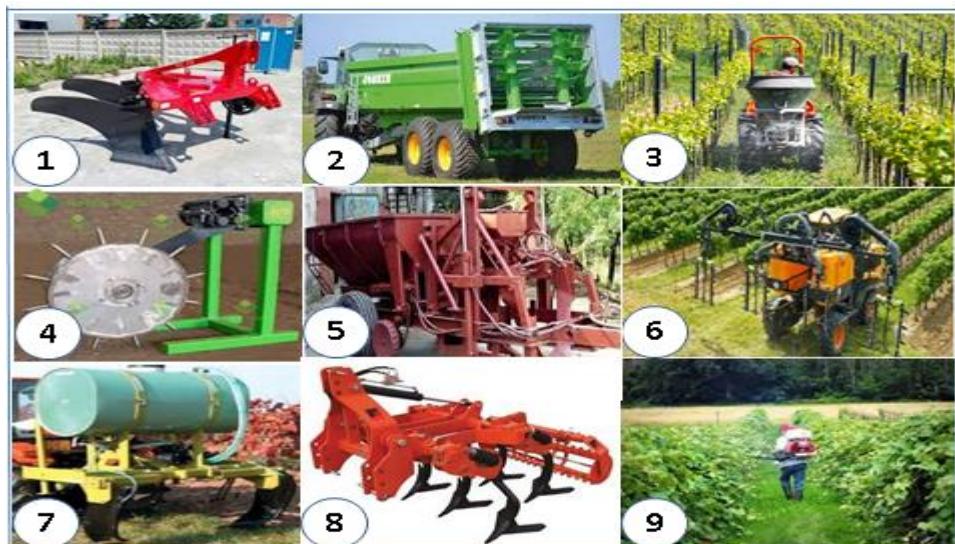
Рис. 3.16 Агрегати для внесення добрив на виноградник. 1. Плуг плантажний; 2. Розкидач органічних добрив; 3. Розкидач мінеральних добрив; 4. Ін'єктор; 5. Багатофункціональний агрегат для передпосадкової обробки ґрунту; 6. Оприскувач; 7. Підживлювач; 8. Культиватор-щільоріз; 9. Ранцевий оприскувач.
